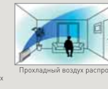
Жалюзи направляют воздушный поток вверх
