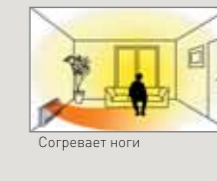
Жалюзи направляют воздушный поток вниз
