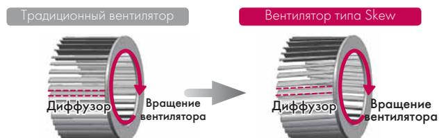
При вращении вентилятора лопасти вентилятора находятся параллельно диффузору (контактируя с диффузором по поверхности лопасти), при этом мгновенный перепад давлений имеет высокое значение.
